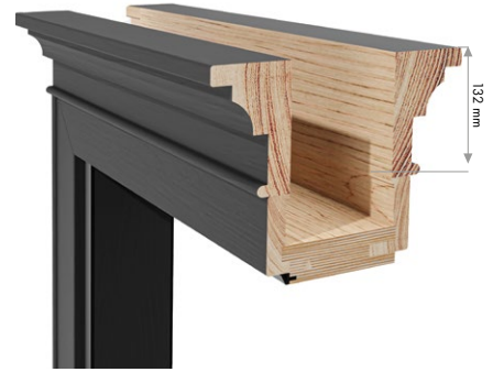
2. Umfassungszarge mit dekorativer Kranzleiste und Zierleiste 73/20 oder 93/20
