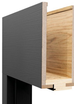
4. Umfassungszarge mit verlängertem Türabschluss – zwischen 261 mm und 1000 mm; Blendrahmen 60/20 oder 80/20
