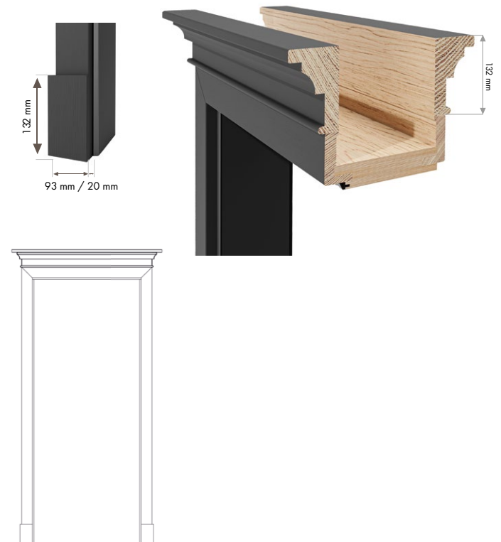
8. Umfassungszarge mit Ziersockel und Kranzleiste Blendrahmen 80/20
